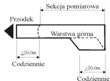
Przekrój wzdłuż wyrobiska
