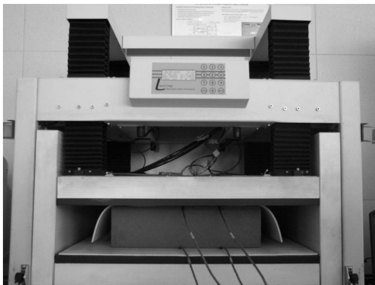
Rys. 2. Badanie przewodności cieplnej aparatem płytowym FOX 600 próbki ziemi ubijanej
