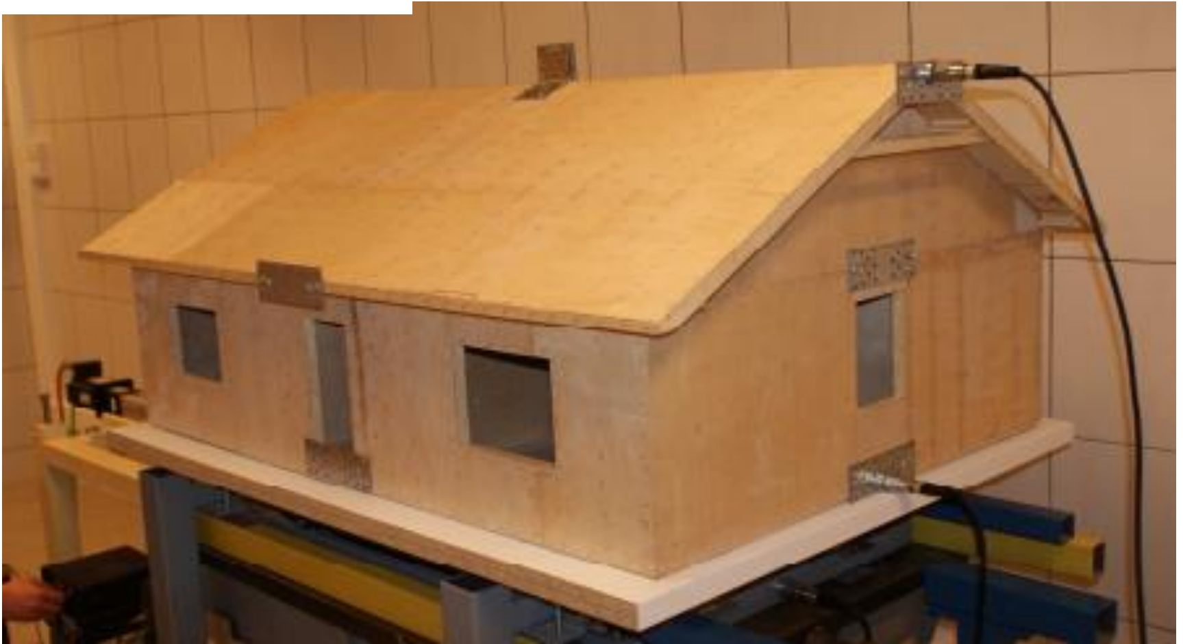
Rys. 1. Eksperymentalne badania dynamiczne modelu drewnianego budynku szkieletowego na stole wstrząsowym
