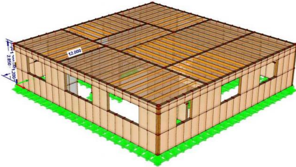
Rys. 3. Model numeryczny rzeczywistej konstrukcji obiektu szkieletowego z wypełnieniem pianką poliuretanową – analiza modalna, trzecia postać drgań własnych
