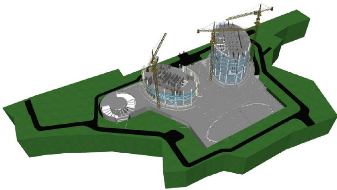
Wizualizacja 3D optymalnego układu żurawi wieżowych
