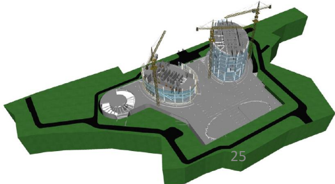
Schemat zautomatyzowanego systemu planowania układu żurawia wieżowego opartego na BIM
